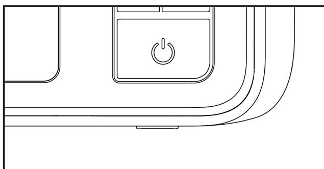
電源ボタンの長押しで、電源のオン/オフが切替ります。
