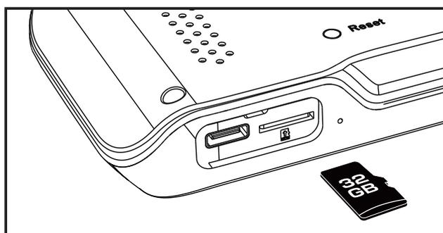
本体には、microSDカード(32GB)が付属し、セット済みになっています。着脱の際は本体の電源を切り、カードを軽く押し込むと外せる状態になります。カードに保存した静止画や動画をPCに保存することができます。
